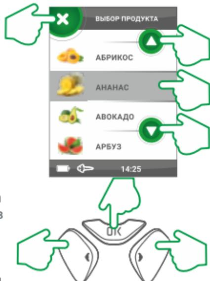
После выбора продукта производится калибровка зонда. Во время калибровки зонд не должен быть в продукте. После калибровки на экране отобразится наименование продукта, норма содержания в нем нитратов в мг/кг и рекомендация о вводе зонда в продукт. Необходимо ввести зонд в продукт, дождаться стабилизации температуры (значение выводится в верхнем правом углу экрана) и нажать пиктограмму «ИЗМЕРИТЬ» на дисплее или нажать кнопку «OK» на приборе.
