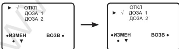
При включенной функции накопления дозы в поле кнопки «С» в режимах «ИЗМЕРЕНИЕ» и «ПОИСК» устанавливается пиктограмма «ДОЗА», указывая, что идет накопление.
